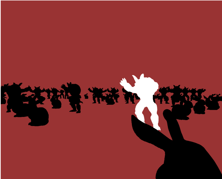
Abbildung 4.1: Ansicht einer Kameraposition bei der Vorberechnung; nur das Objekt, dessen Größe bestimmt werden soll wird weiß, alle anderen Objekte schwarz dargestellt
