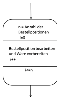
Abbildung 2.6: Beispiel für ein Schleifenkonstrukt
