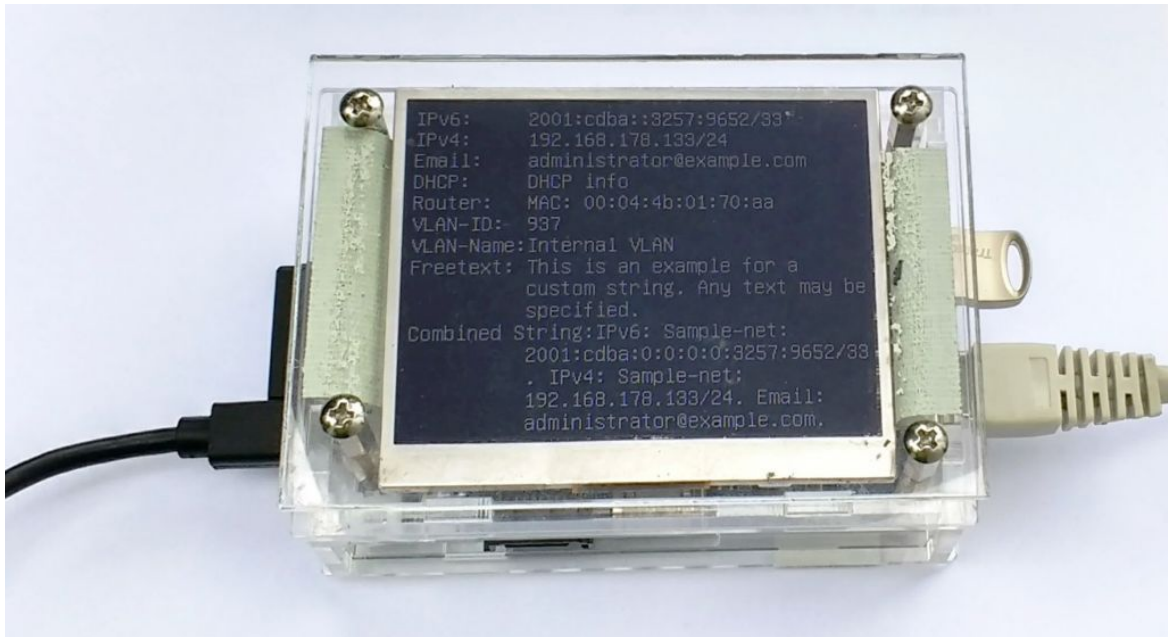
Abbildung 5.4: Kleinrechner mit Display während der Ausführung des LAN-Beacon Prototypen im Empfängermodus
