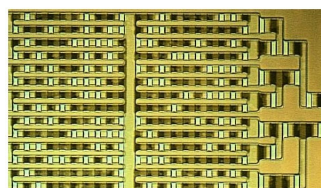
Abbildung 8: geätzte ROM-Speicherzellen unter dem Miskroskop
