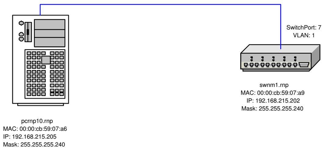
Abbildung 5.1: Beispielmodellierung Rechner mit Ethernet-Switch
