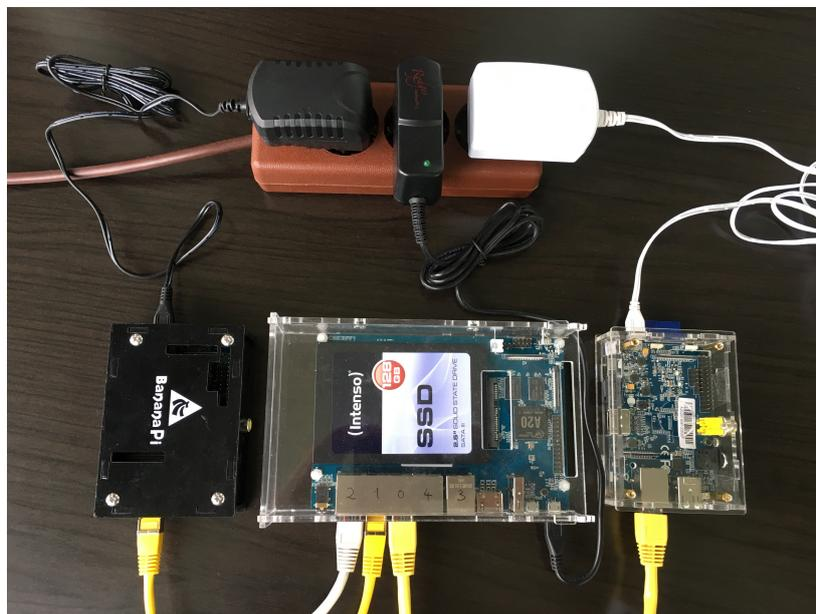
Abbildung 3.2.: Foto des für die Arbeit erstellten Virtualisierungsclusters
