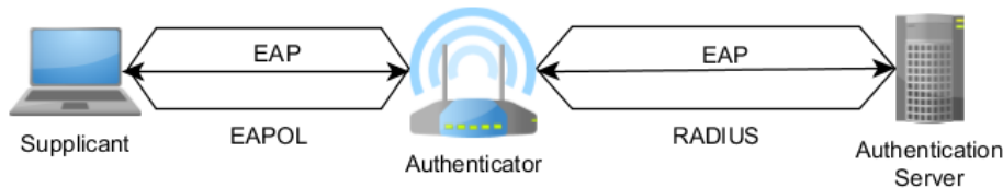
Abbildung 2.2: Infrastruktur bei 802.1X mit einem Supplicant
