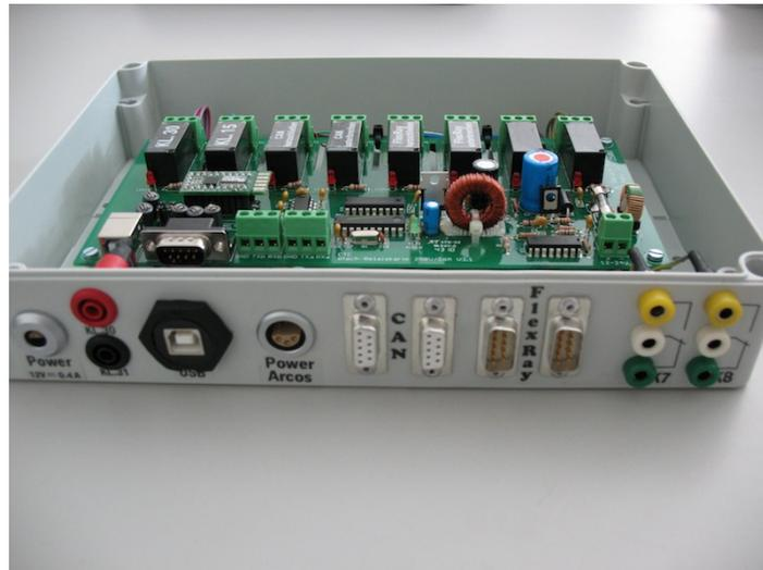
Abbildung 5.4: Eingebautes Relaisboard
