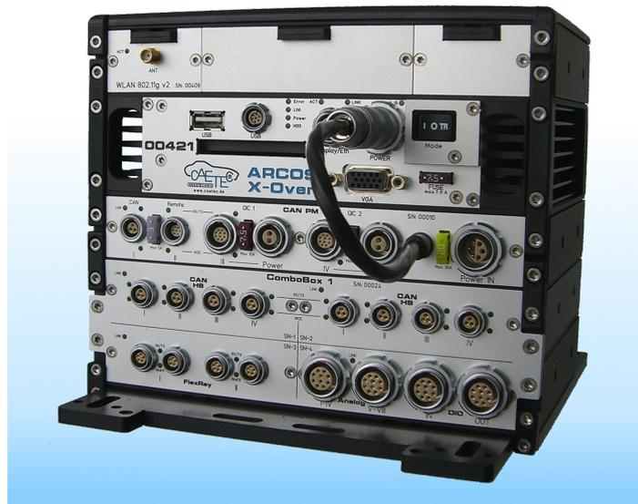
Abbildung 5.1: ARCOS Datenlogger der Firma CAETEC
