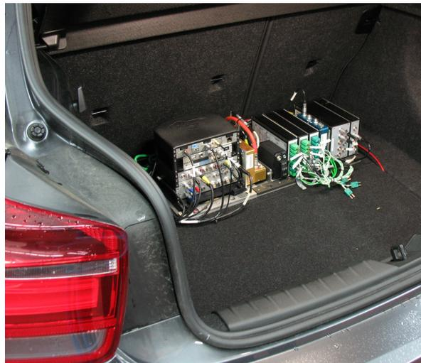
Abbildung 2.1: Datenlogger im Kofferraum verbaut
