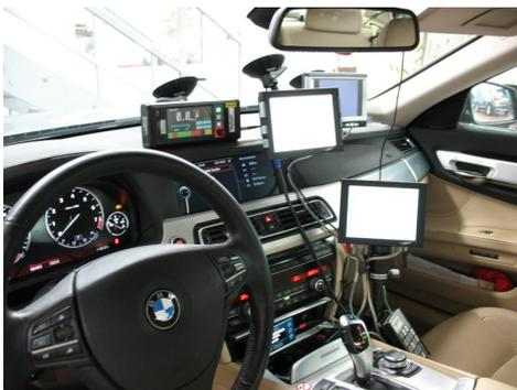
Abbildung 1.1: Anzeigeelemente im Fahrerblickfeld
