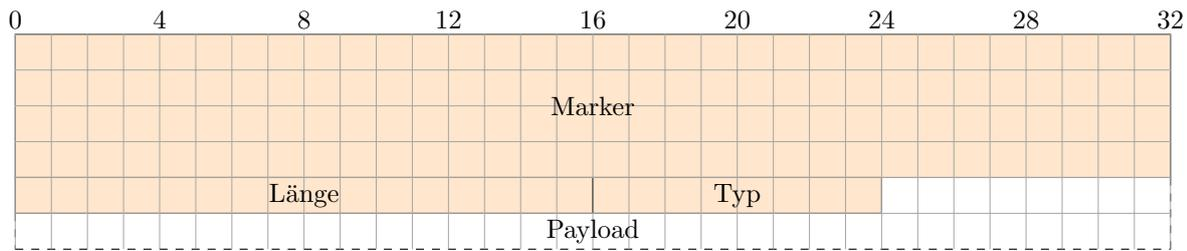
Abbildung 3.2: BGP Header mit anschließendem Payload
