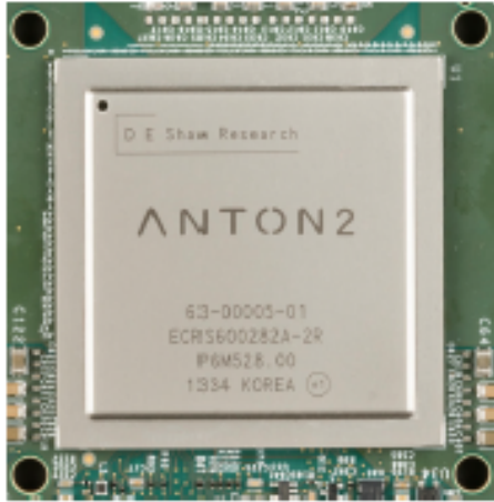
Abbildung 3: Eine Draufsicht auf einen einzelnen ASIC Baustein der Anton 2 Architektur. [3]
