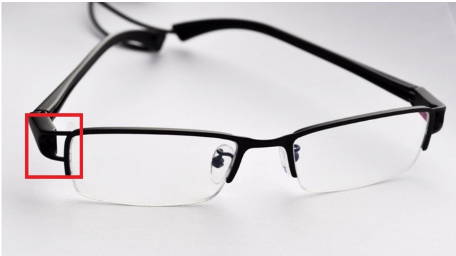
Abbildung 3.3: Brill mit integrierter HD Kamera. (vgl. [Spy16])
